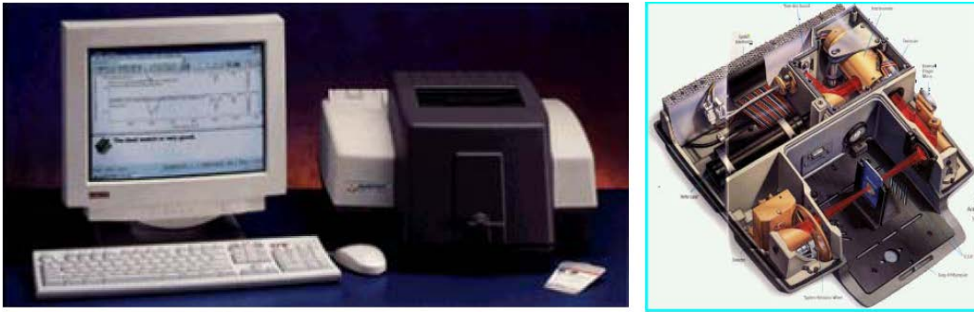
图 1. 所使用的傅立叶变换红外光谱仪及其内部构造
