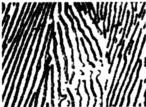
图 3-5 共析钢的显微组织(高倍)
