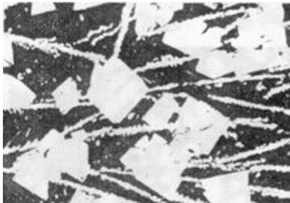
图 27.4 铸态 ZChSnSb11-6 轴承合金 500 \times 浸蚀剂: 4%硝酸酒精溶
