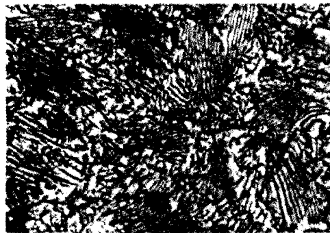
图 3-4 共析钢的显微组织(中倍)
