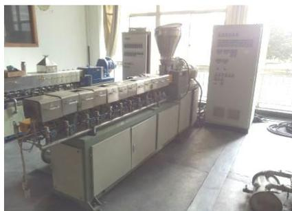
双螺杆橡胶脱硫装置
