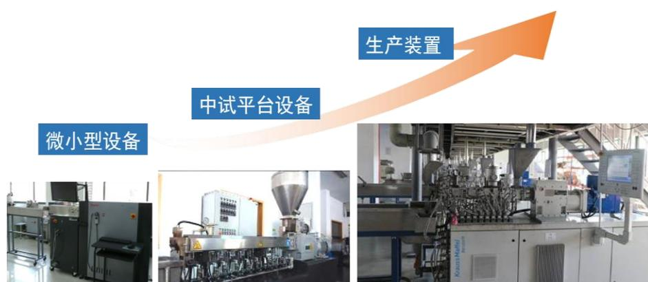
图 15 系列化双螺杆挤出机装置
